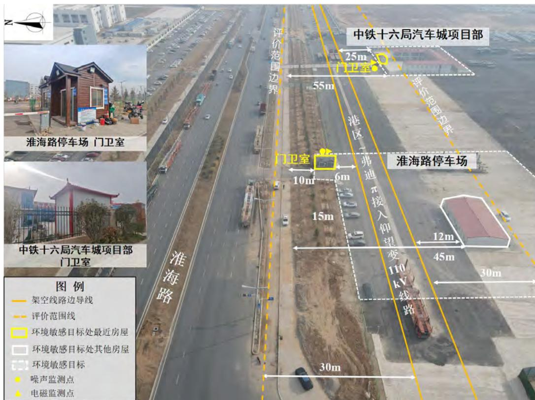
图 9 港区~弗迪  $\pi$  接入仰望变 110kV 线路与环境敏感目标位置关系及监测布点示意图（淮海路停车场、中铁十六局汽车城项目部）
