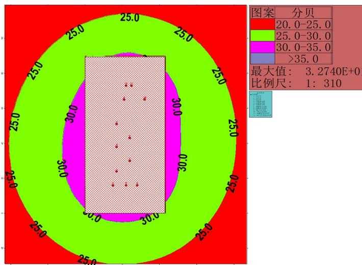
图 4-5 变电站厂界噪声贡献值预测结果 (dB (A))
