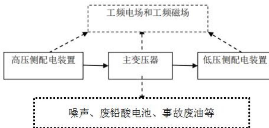
图 4-4 变电站运行期工艺流程及产污环节图
