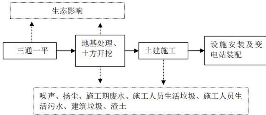
图 4-1 变电站施工工艺和产污环节图
