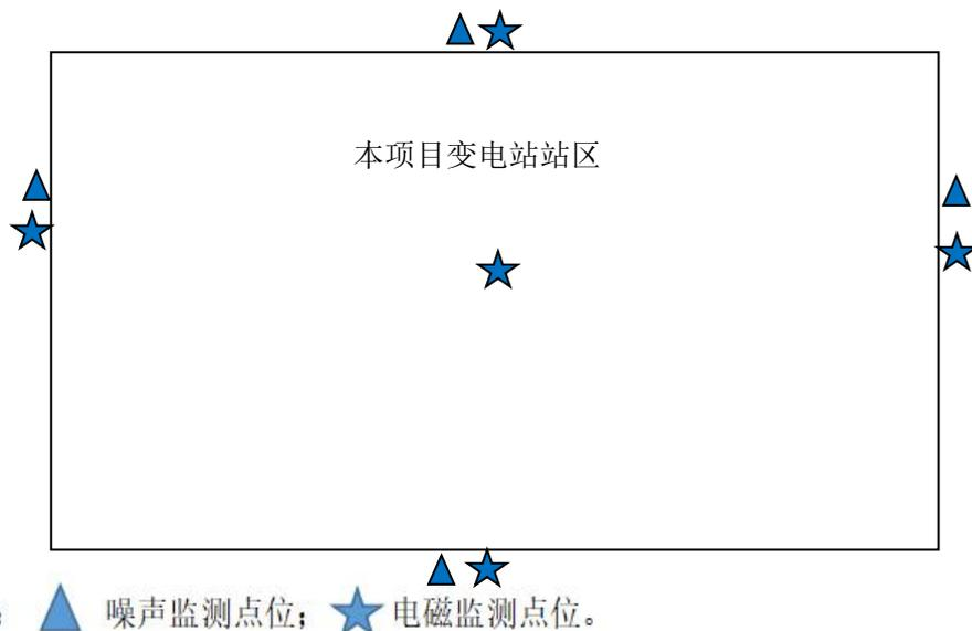
图3-2 建设项目环境噪声及电磁监测位示意图
